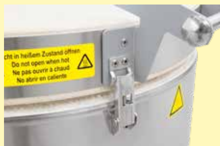
Deckel einstellbar und mit Schnellverschluss
