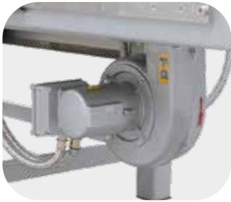
Kühlgebläse zum beschleunigten Abkühlen bei geschlossenem Deckel
