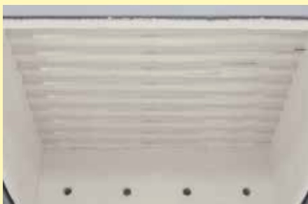
Dicht nebeneinander angeordnete Deckenheizelemente, geschützt in Quarzglasrohren
